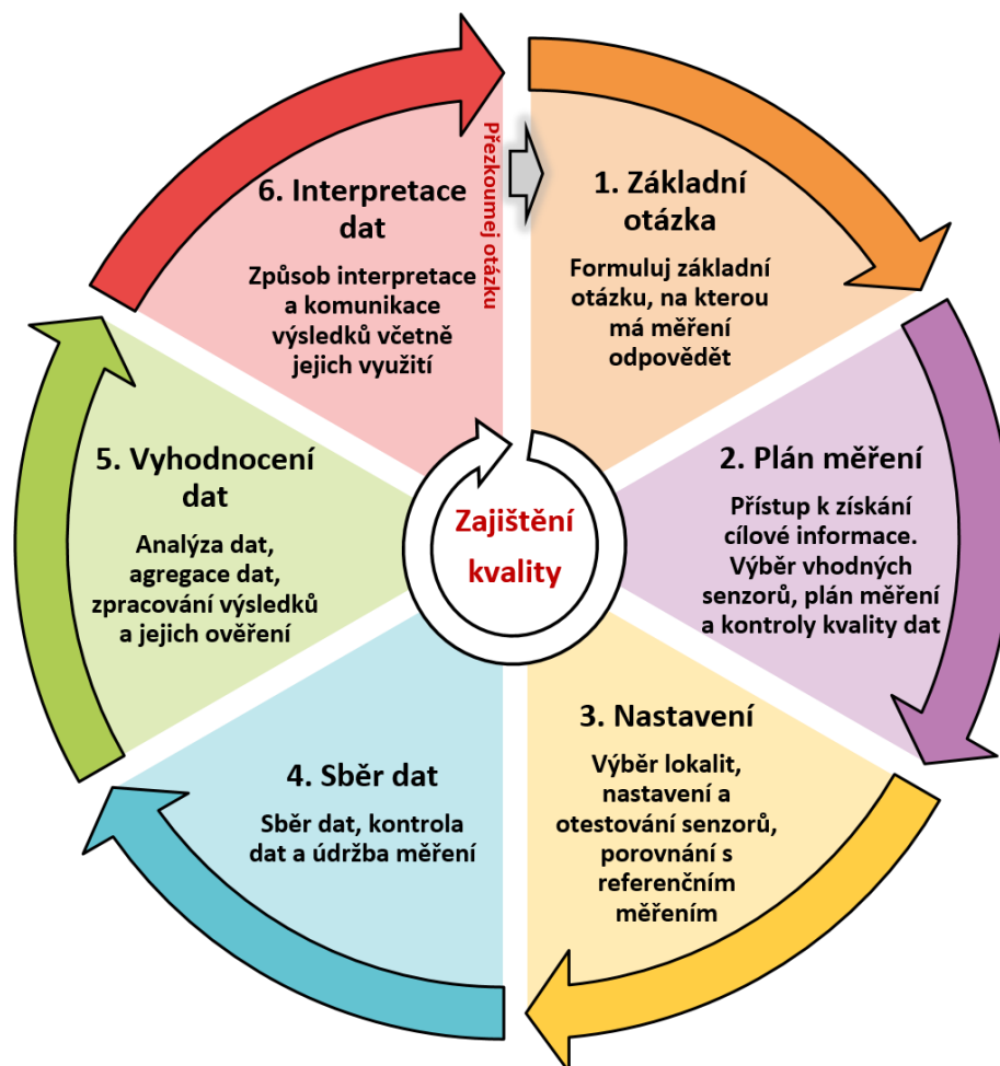
Obr. 12. Základní kroky důležité při plánování záměru monitoringu kvality ovzduší pomocí senzorových zařízení. Upravený zdroj 3 .
